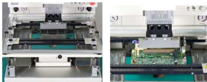
噴流ノズル . . . . . トップノズル
